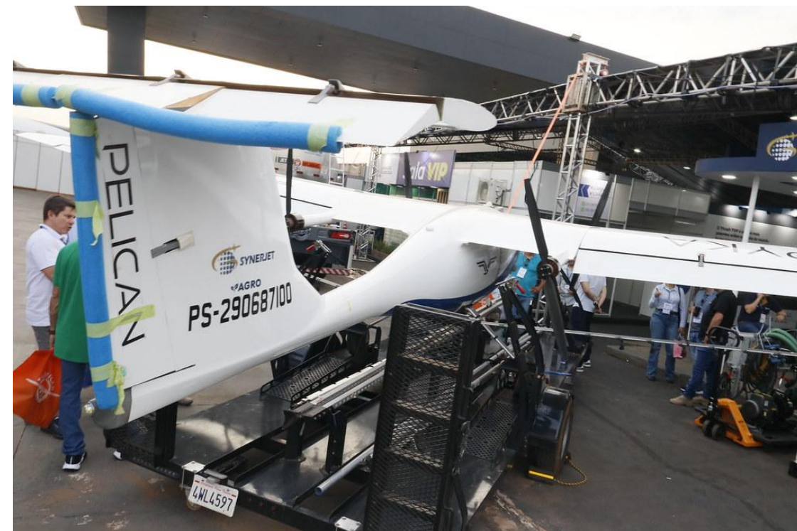
Pelican, da Synerjet Aeronave agrícola autônoma, 100% elétrica
