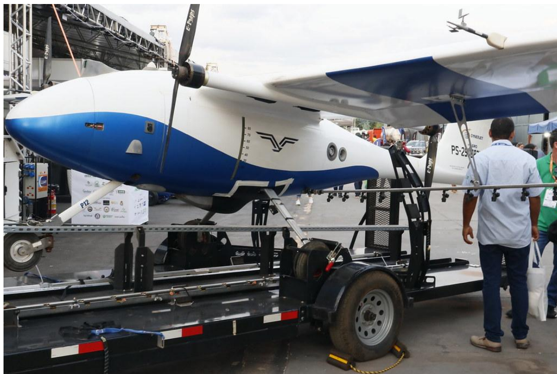
Pelican, da Synerjet Aeronave agrícola autônoma, 100% elétrica
